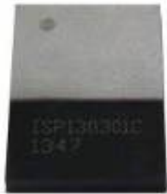
BLE module with embedded antenna
