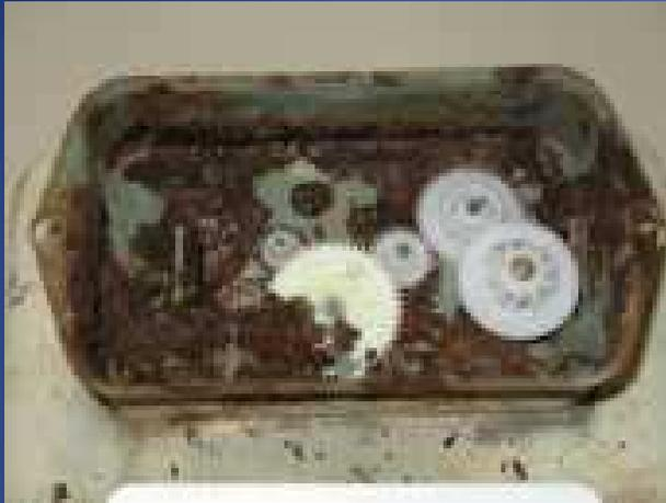
La verifica dell'integrità dei componenti del totalizzatore ha evidenziato segni di elevata **corrosione dei supporti degli alberini degli ingranaggi, che causa l'interruzione della trasmissione dal gruppo misura alle tamburelle.**
